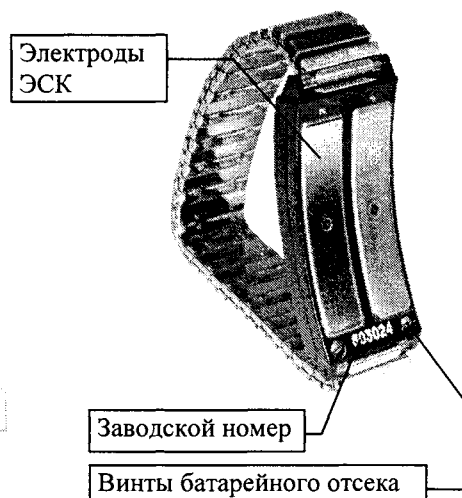
Рис. А.1б. Прибор ТСКБМ-Н со стороны, прилегающей к руке.
