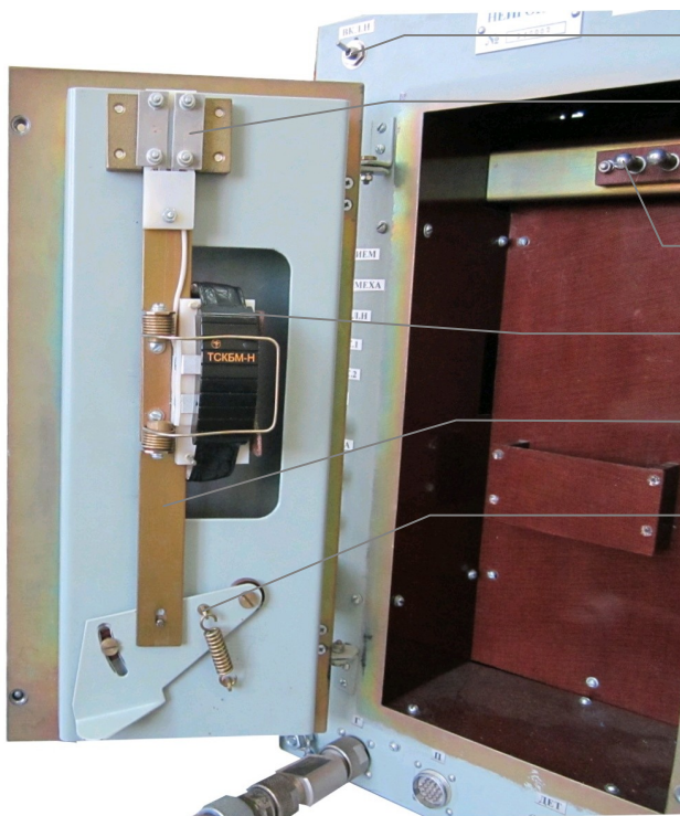
а) Общий вид установки прибора ТСКБМ-Н НКРМ.464213.006 в узел крепления ТСКБМ-Н экранированного отсека блока ТС-ТСКБМ.
