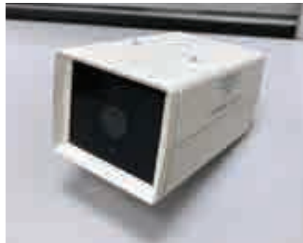
Инфракрасная видеокамера с подсветкой рассеяным излучением
